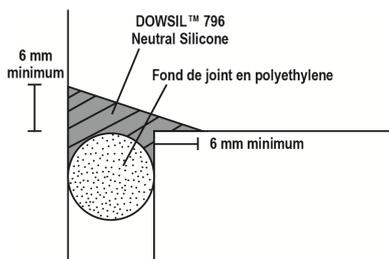
**Figure 3:** Joint d'angle
